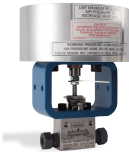
10V6071-C1S 气动关闭（常开） 活塞式气动阀门
